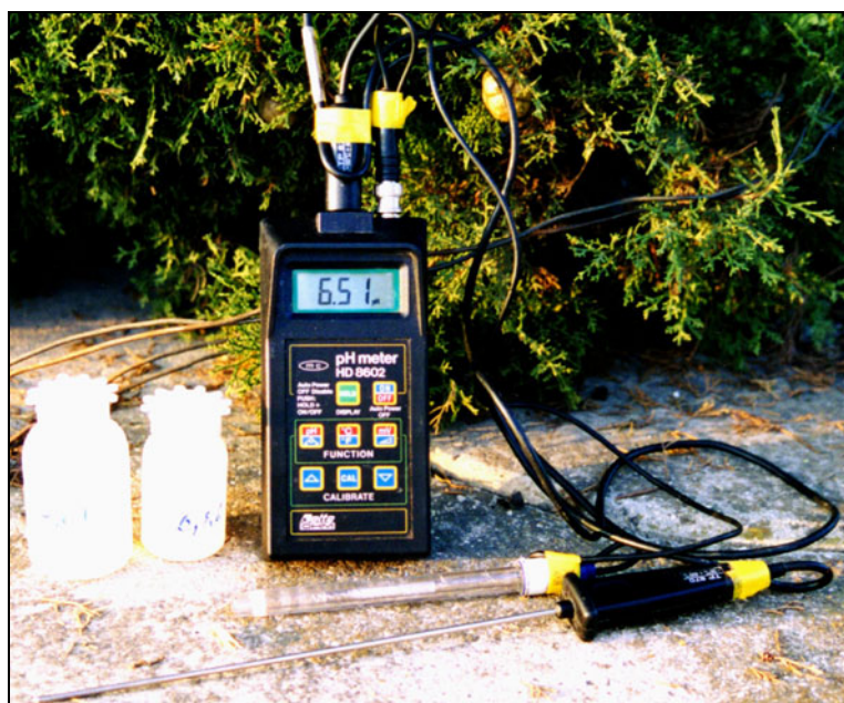
Figura 10.1 Piaccametro, strumento utilizzato durante le campagne di acquisizione dati per misurare i valori di pH
