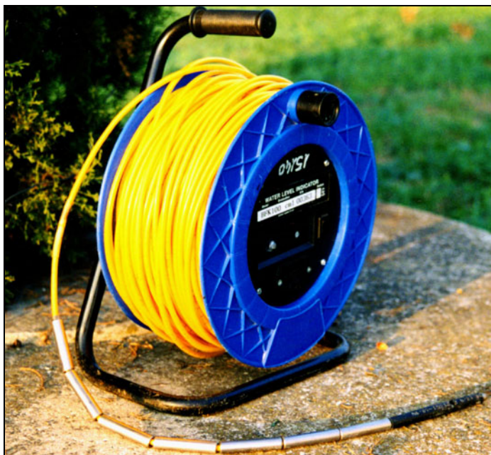
Figura 9-1 Freaticometro, strumento utilizzato nella ricerca idrogeologica per effettuare misure di profondità della superficie piezometrica
