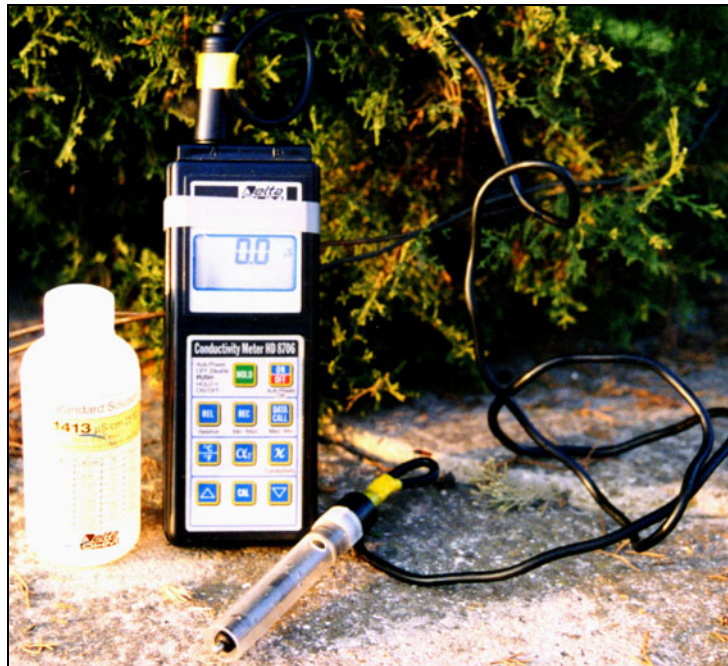
Figura 10-6 Conducimetro, strumento utilizzato durante le campagne di acquisizione dati per misurare i valori di conducibilità
