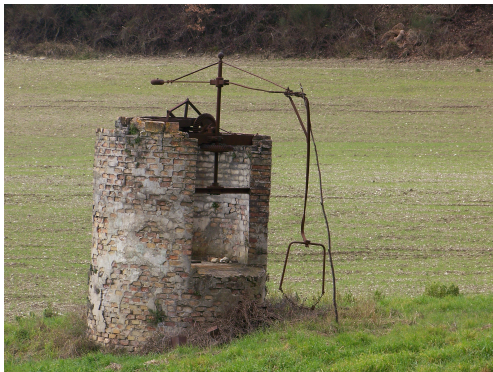
“Pozzo con meccanismo per attingere acqua con l'aiuto di un animale” - Fossombrone
