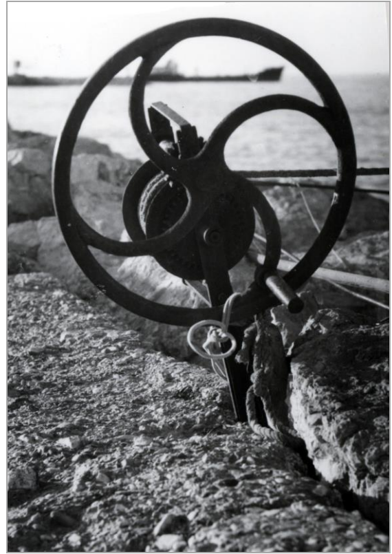
Aprile 1967, Porto di Fano. Verricello di ferro sul molo, usato per sollevare un piccolo quadro, la lugérna , montata su un carrello mobile
